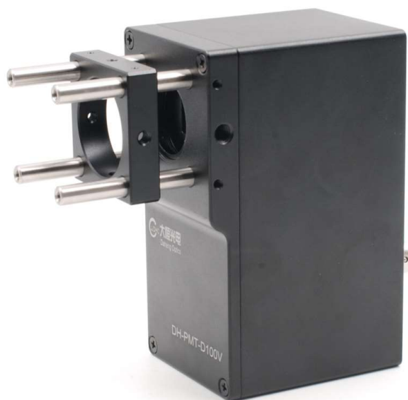
图 2.3.1 笼式上使用倍增管探测器
