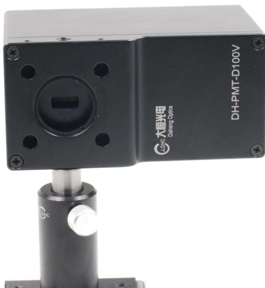
图 2.3.2 支杆支撑使用倍增管
